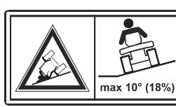
Ne pas rouler sur des pentes de plus de 10° (18 %) d'inclinaison !
